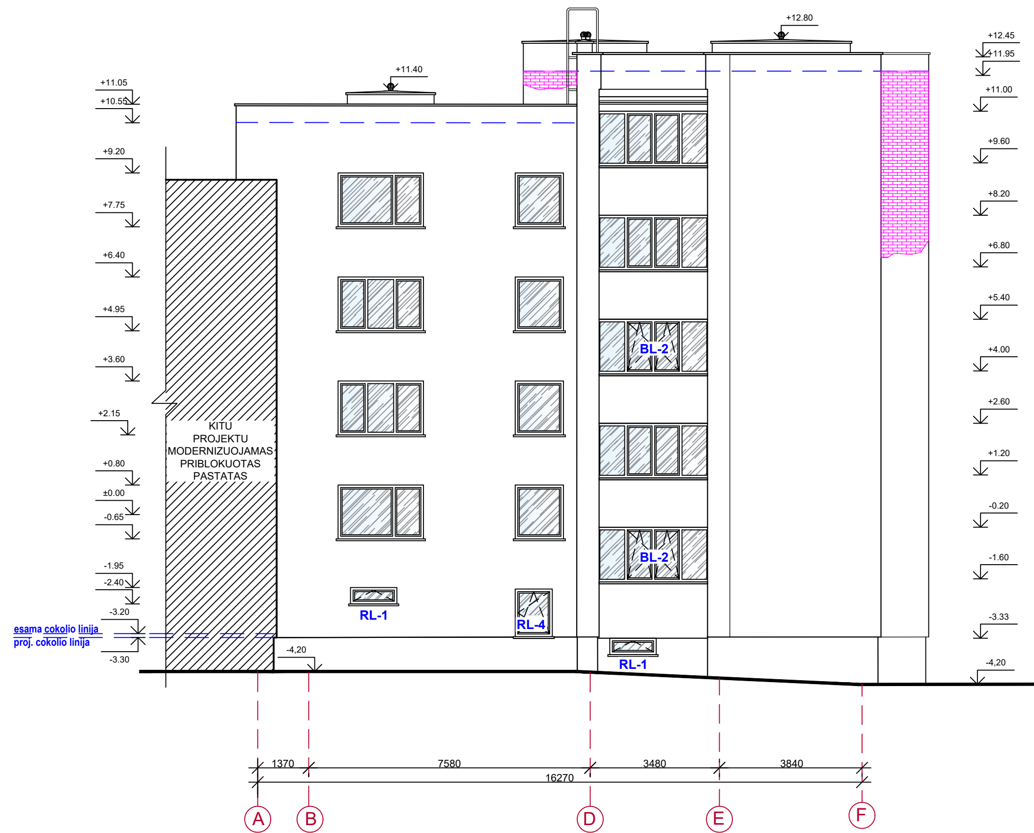
FASADAS TARP AŠIŲ "A-F" M 1:100
